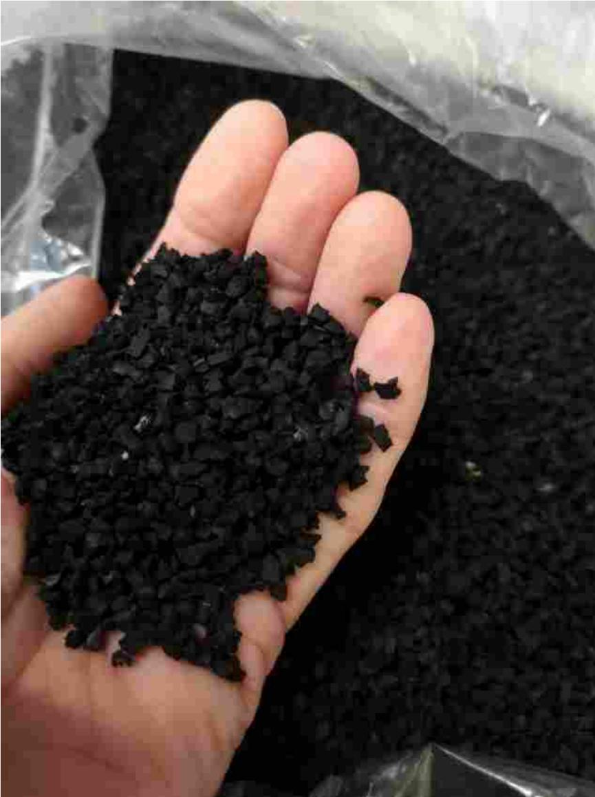
*Il granulato generato da pneumatici e camere d'aria da bici*
